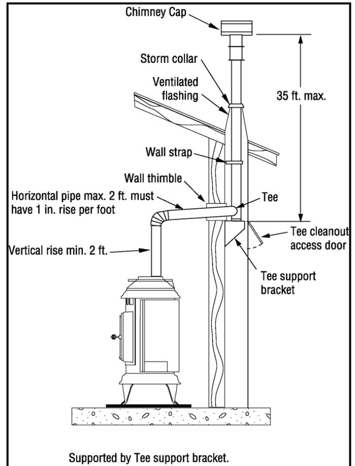
**FIGURE 10. CHIMNEY THROUGH OUTER WALL AND ENCLOSED**
